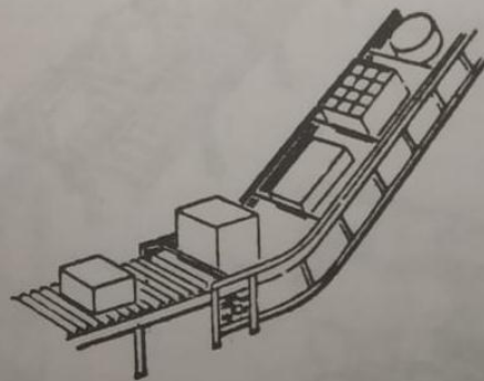
Fig. 25.27. Pusher bar conveyor.
